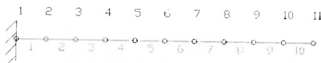
FIGURA 27: MALHA UTILIZADA NA SIMULAÇÃO NUMÉRICA DA VIGA EM BALANÇO. EM AZUL SÃO APRESENTADOS OS ELEMENTOS E EM PRETO OS NÓS.
